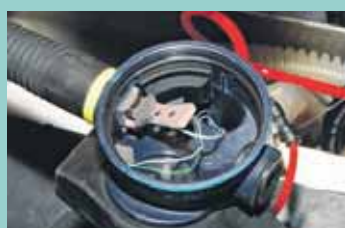
Diese zweite Stufe ist mit zwei Sensoren ausgestattet, die die Oberflächentemperatur erfassen.
