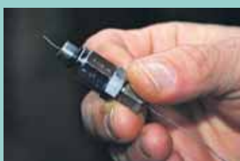
Messeinheit zum Einschrauben in die erste Stufe
